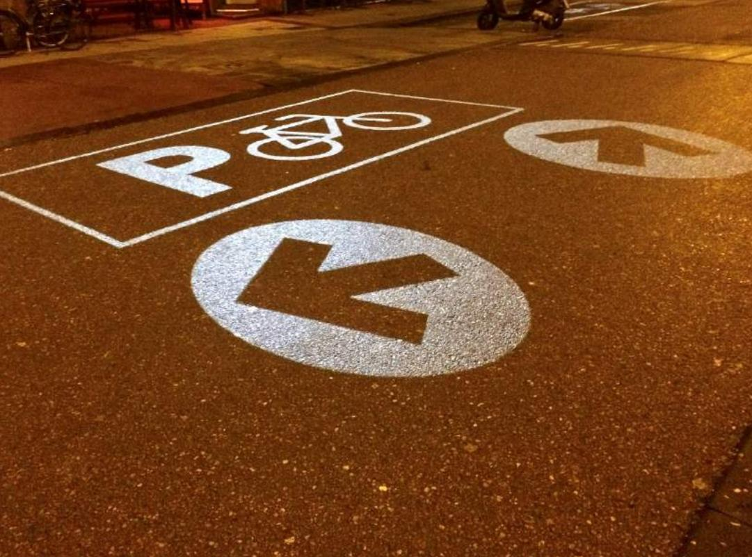
Esempio di soluzione per la gestione della sosta temporanea notturna adottato dalla Città di Amsterdam per il vivace quartiere di De Pijp. La soluzione proietta un fascio di luce demarcando dove è consentita la sosta temporanea.
